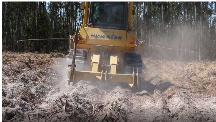
Figura 3e - Ripagem com 1 ferro em Ançã, após a realização de uma gradagem total / contínua em toda a área. Tratamento Operacional testado em todos os ensaios (maio 2018).
